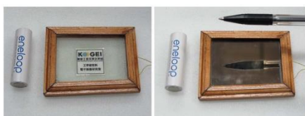
バイアス電圧(-2.5V)印加時：鏡状態
